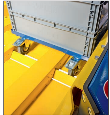
Automatisches Arretieren der Bodenroller beim Anheben der Inlate-Brücke
